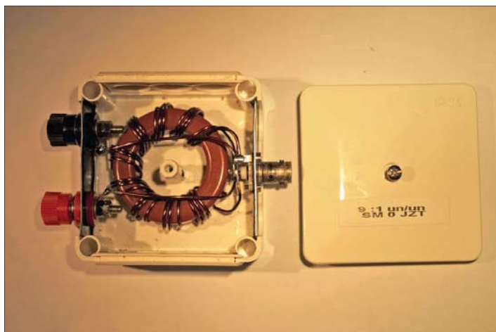
Fig 4: Det färdiga resultatet i sin elkopplingsdosa. Kontakterna har monterats i plåttbitar nedstuckna i gavarna eftersom kopplingsdosans sidostycken är av mjuk plast. Välj den inkapslingslösning som passar dig bäst.
